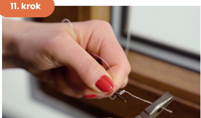
Utáhněte uzel na silonu a **zbývající část zkrátte**.
